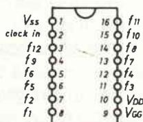
Figura 1 - Piedinatura e schema a blocchi dell'integrato
